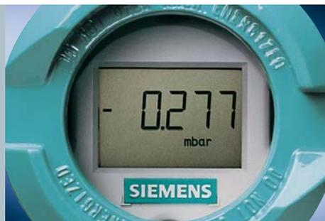
Le transmetteur SITRANS P DS III porte le qualificatif « sécuritaire » pour la pression, la pression différentielle, le débit, la pression absolue et le niveau de remplissage. Le transmetteur dispose d'une certification SIL 2 selon IEC 61508/61511. Les fonctions de sécurité comprennent entre autres le diagnostic automatique, le comportement en cas de défaut et le calcul du taux de défaillance.
